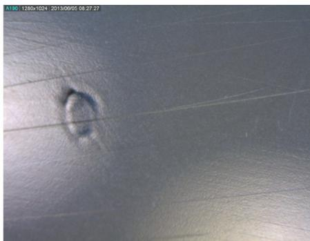
**Рис. 29.1.** Увеличенная фотография поверхности отливки с отслоением
