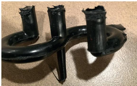
**Рис. 29.3.** Разводящий литник с обломом, который привел к отслаиванию
